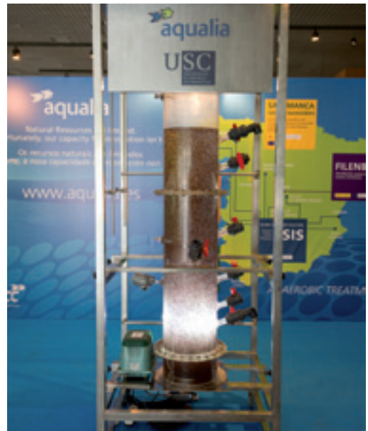
Muestra del piloto de tecnología Anammox desarrollado en colaboración con la Universidad de Santiago de Compostela en el Congreso AD13.
