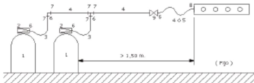
**INSTALACIÓN COMPUESTA POR DOS BOTELLAS CONECTADAS EN BATERÍA A UNA COCINA FJA SITUADA A MENOS DE 1,50 METROS**
