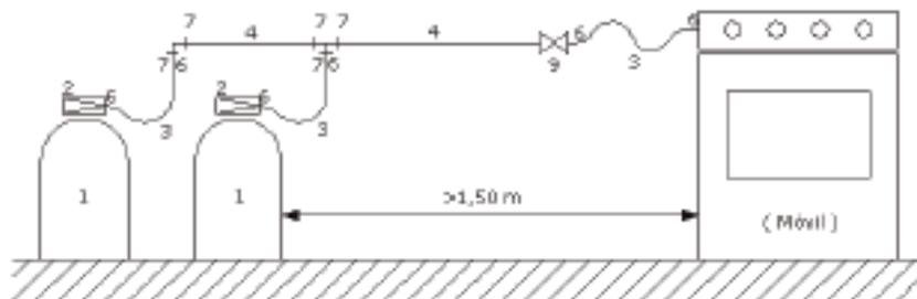
**INSTALACIÓN COMPUESTA POR DOS BOTELLAS CONECTADAS EN BATERÍA A UNA COCINA MÓVIL SITUADA A MENOS DE 1,50 METROS**
