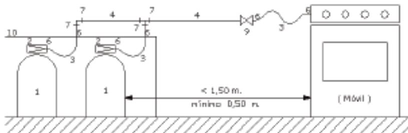
**INSTALACIÓN COMPUESTA POR DOS BOTELLAS CONECTADAS EN BATERÍA A UNA COCINA Fija SITUADA A MÁS DE 1,50 METROS**
