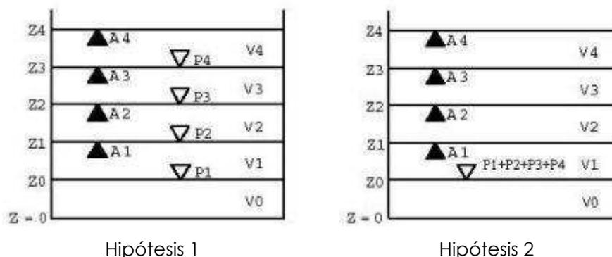
En ambas hipótesis, conforme aumenta el caudal de entrada, van entrando en accionamiento las distintas bombas. En la hipótesis 1, al disminuir el citado caudal de entrada, las bombas van
