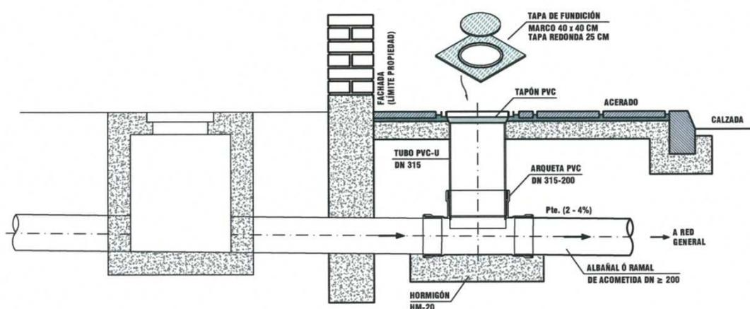
En las edificaciones con sótano, con objeto de que la propiedad pueda realizar el mantenimiento de la instalación interior, se instalará como elemento de registro, en línea con la acometida una pieza en "Y" a 45° con tapón de registro para permitir su limpieza. Para su ubicación se aplicarán los mismos criterios que en el caso de la arqueta, es decir, zona común.
