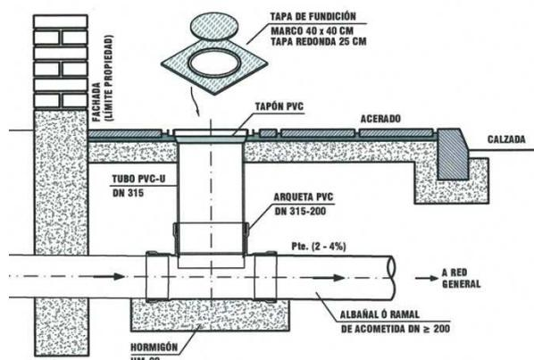
El tubo vertical hasta el nivel del acerado será de PVC-U de pared compacta DN 315 mm con tapón de PVC incorporado para evitar la salida de gases y olores y conexión con el colector general mediante clip. Y en la parte superior se rematará, a nivel de acerado, con un registro de marco cuadrado de 40 x 40 cm y tapa redonda de 25 cm de diámetro.
