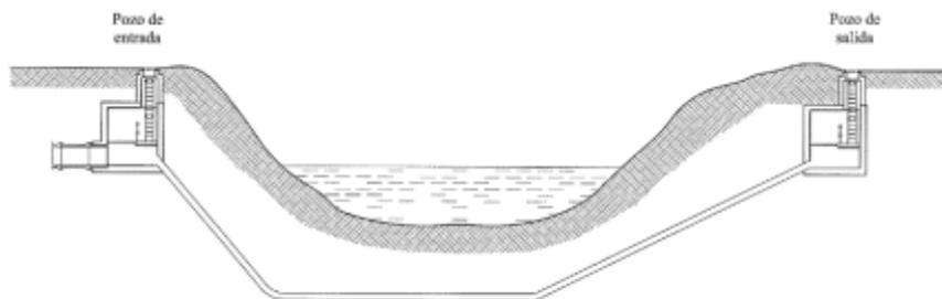
Fig 50. Esquema de sifón
